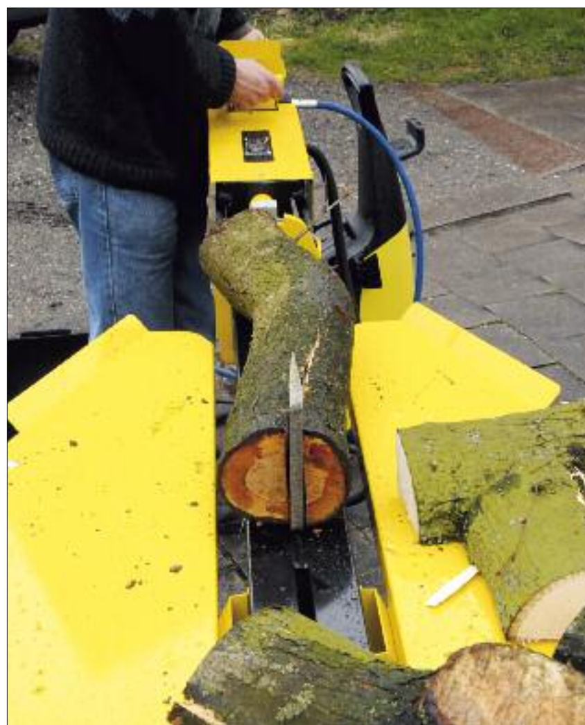
Einsatz von Spaltkeilen aus besonders hochwertigen, durchgehärtetem Stahl.
