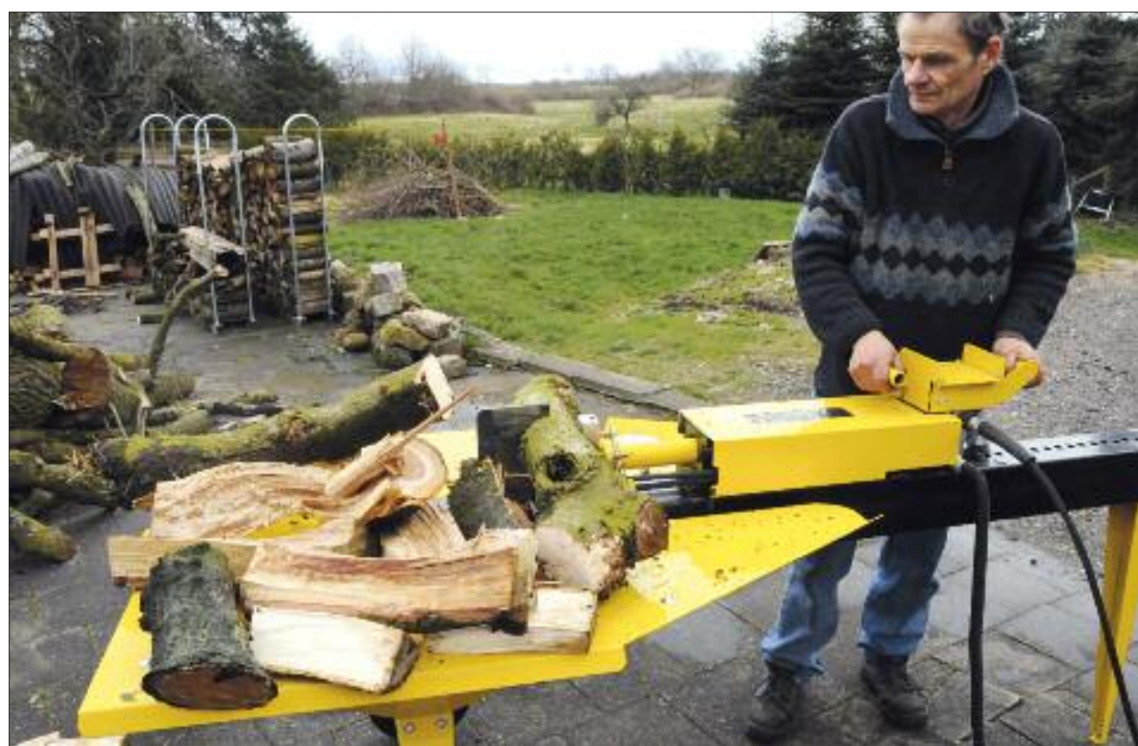
Die durch Wasserhydraulik betriebenen Maschinen können Holz auch querspalten.
